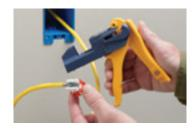
Soltar el asa y retirar el conector de la herramienta JackRapid. Realizar una inspección visual para asegurar que se ha efectuado una terminación correcta.
