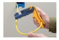
Pelar el cable del conector con un pelador de cables estándar o con el pelador de cables integrado.
