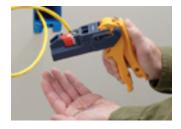
Los cables quedarán cortados y asentados asegurando una sólida terminación.
