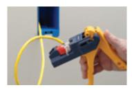
Asegurarse de que el conector se encuentra insertado totalmente y de forma segura en el alojamiento para conectores con las ranuras IDC en dirección a las cuchillas.
