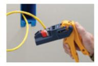
Apretar el asa completamente y retirar el exceso de cable antes de volver a soltarla.
